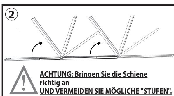
Bewegen Sie die Steckverbindung in die Mitte der ersten beiden Schienen und heben Sie die Rippen wie auf der Abbildung gezeigt an.
